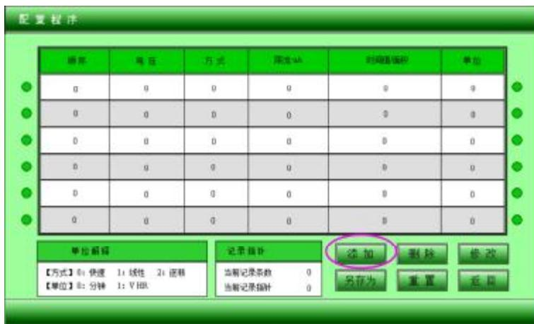
添加：对每一步中电压，升压方式，限流，时间，时间单位，温度进行设定添加。每一个程序可以设定多大六步。
