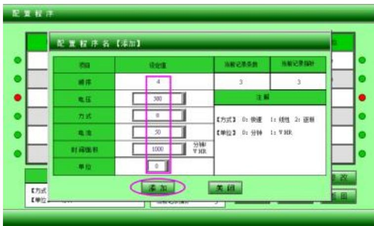
添加：实验预设程序第四步完成，轻按添加键，各种参数即刻进入第四步栏，同时栏两侧红灯亮起。
