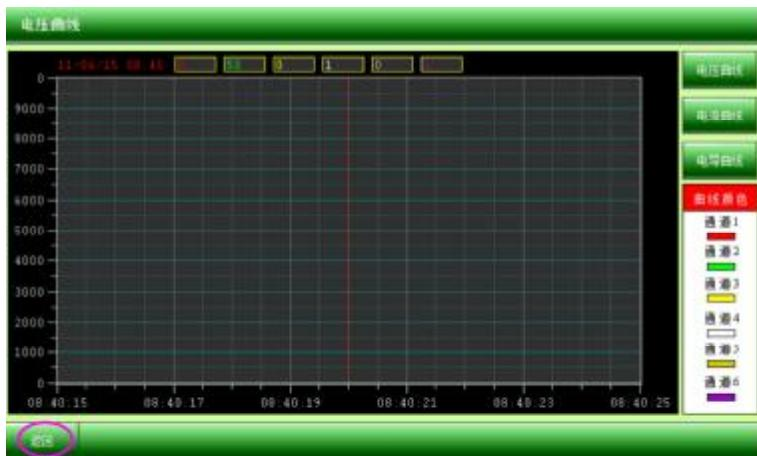
通道电压或电流或电导参数随时间变化情况实时显示窗口，不同通道运行变化以不同颜色显示。返回即进入上一窗口。
