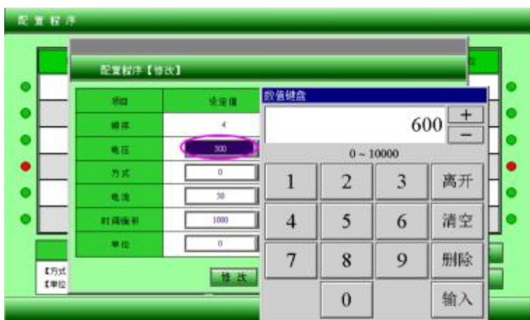
显示第四步中各种参数修改。修改电压为 600V (举例)
