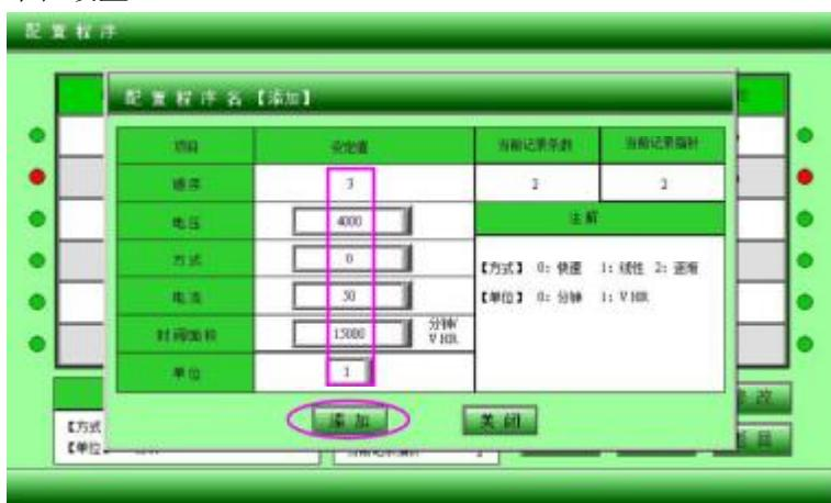
添加: 实验预设程序第三步完成, 轻按添加键, 各种参数即刻进入第三步栏, 同时栏两侧红灯亮起。
