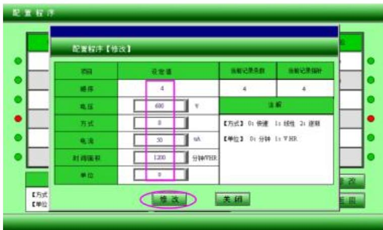
对程序中第四步各种参数修改进行确认（电压及时间已修改）（举例），轻按修改（修改数据保存）。之后轻按关闭，回到各步骤显示程序（下图）。
