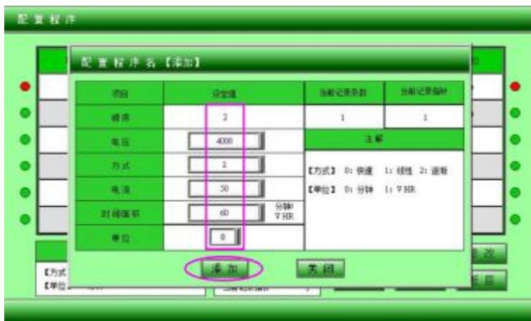
添加：实验预设程序第二步完成，轻按添加键，各种参数即刻进入第二步栏，同时栏两侧红灯亮起。
