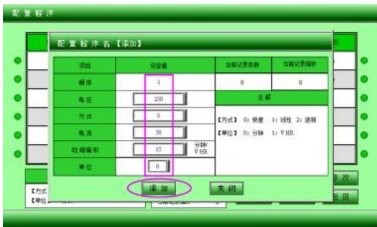
添加：实验预设程序第一步完成，轻按添加键，各种参数即刻进入第一步栏，同时栏两侧红灯亮起。
