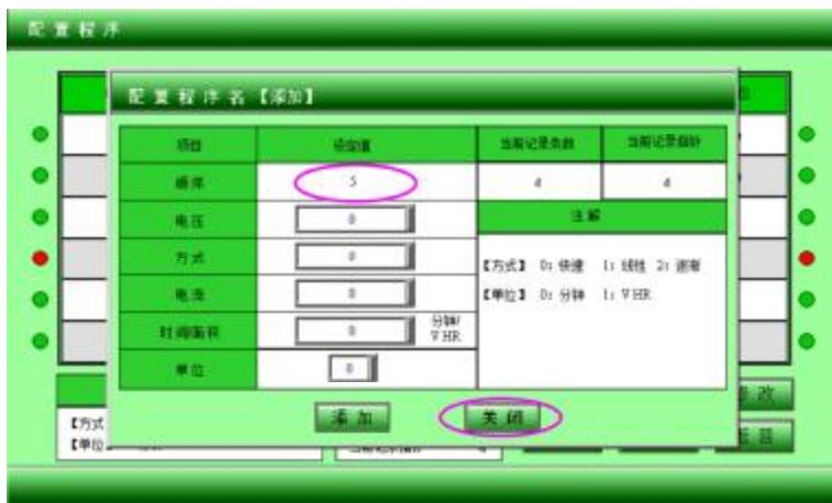
实验程序第五步设置。如果没有第五步程序，轻按关闭键，即进入预设配置程序，同时检查已设程序各种参数。
